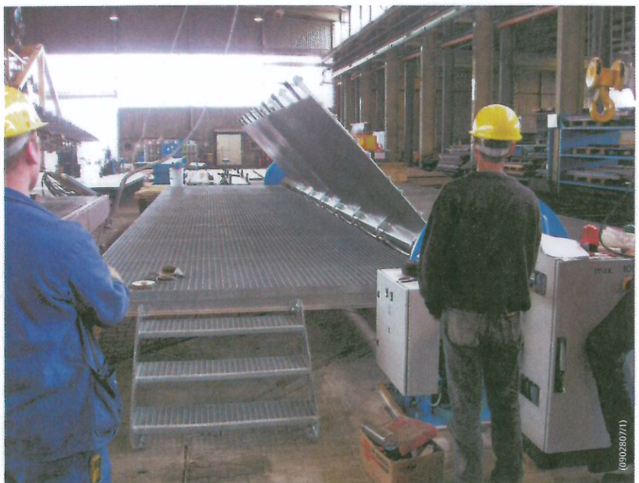
Das Hebegerät von AERO-LIFT ermöglicht durch seine beiden Schwenkgetriebe das lageleichte Wenden der Stahlbleche um 180° (Foto: AERO-LIFT).
