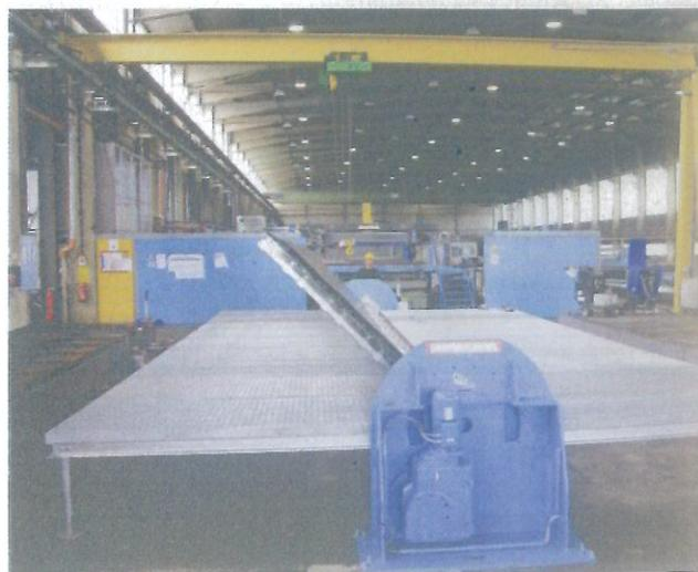
**Leichte Übung:** Das Hebegerät ermöglicht durch seine beiden Schwergetriebe das lageleichte Wenden von Stahlblechen um 180°
