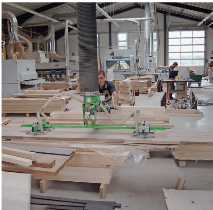
/ Sägen–Heben–Senken–Lösen: Asterix-Kräfte verleiht diesem Mitarbeiter der Schreinerei Ihle, Erbach Ringingen, z. B. ein Schlauchheber. Beim Bau von ...
