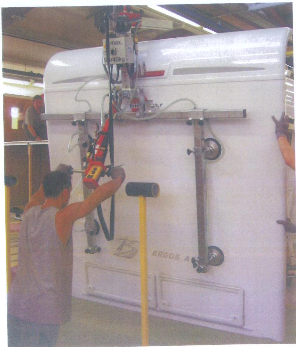
Vakuum-Hebegeräte wie das hier gezeigte Aero 90/40/4R werden bei Bürstner für verschiedene Aufgaben eingesetzt, zum Beispiel, um ganze Heckteile aufzunehmen, zum Fahrzeug zu transportieren und zu positionieren.
