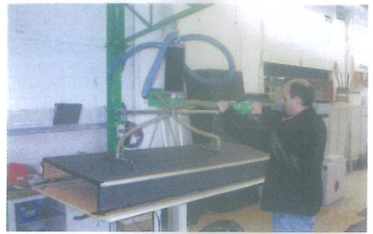
Mit dem Aero Schlauchheber Multi Lift 50 werden große
