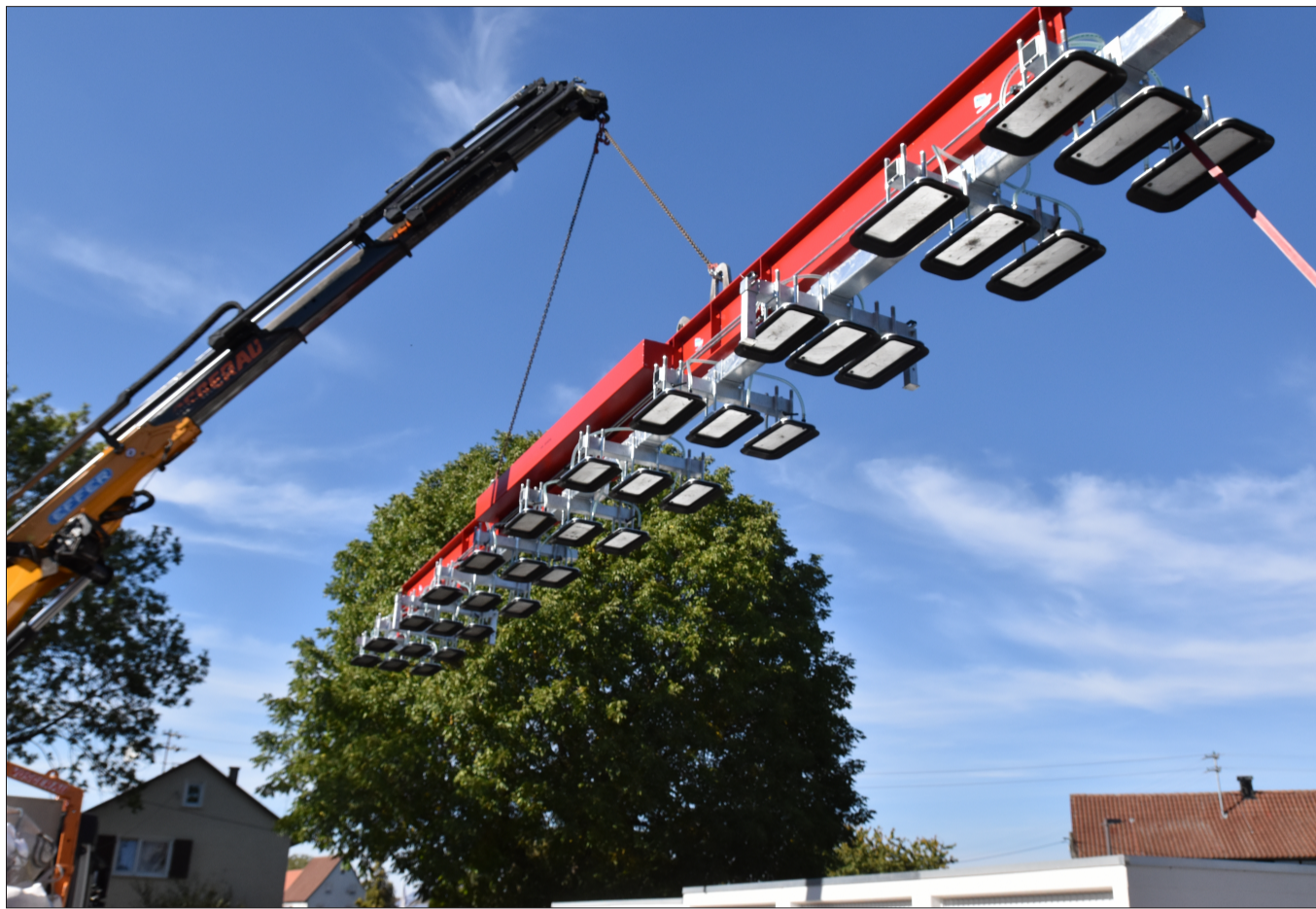
In sechs Metern Höhe hängt das Aerolift-Vakuumhebergerät an einem Schwerlastkran. Verschickt wurde es dieser Tage nach Dänemark.
