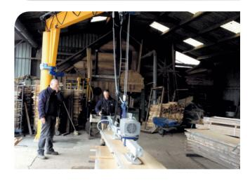
La commande du pont roulant pour les deux types d'appareils AERO-TIMBER et **AERO-PORO** peut s'effectuer au moyen de la télécommande de l'appareil. Pour cela, la commande du pont roulant peut être intégrée à la commande de l'appareil. Ceci permet de comman-
