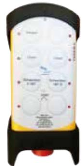
Dazu wird die Steuerung des Hallenkrans in die Steuerung des Gerätes integriert. So können sehr bequem alle Funktionen des Hallenkrans (Heben, Senken, Rechts, Links, Vor, Zurück) und alle Funktionen des Vakuumhebeegerätes (Saugen, Lösen, 90° Schwenken), mit einer einzigen Funkfernbedienung gesteuert werden.
