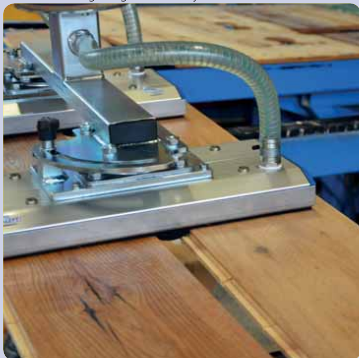
Heben von Holzbodensegmenten
