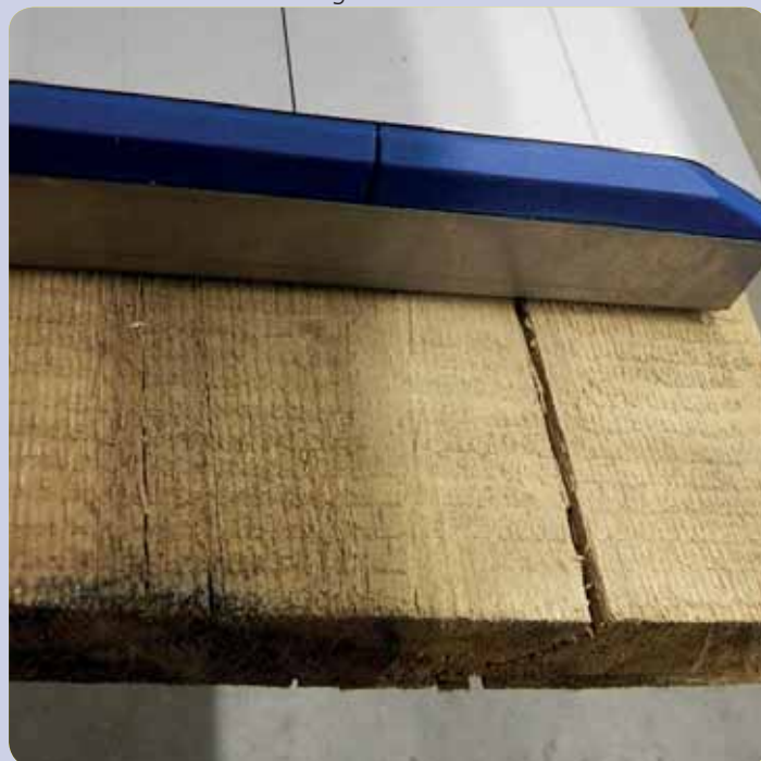
Heben von Holzbrettern mit Rissen oder Ausbrüchen
