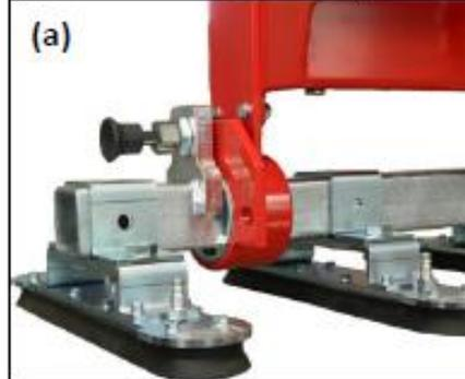
Nachdem die Paneele leicht geschwenkt ist Verriegelungsbolzen zurückdrehen, damit Bolzen einrastet, wenn Paneele senkrecht hängt (b).
