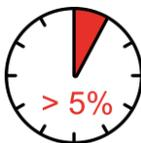
Wenn der Vakuumverlust größer als 5% innerhalb von 5 Minuten ist.
