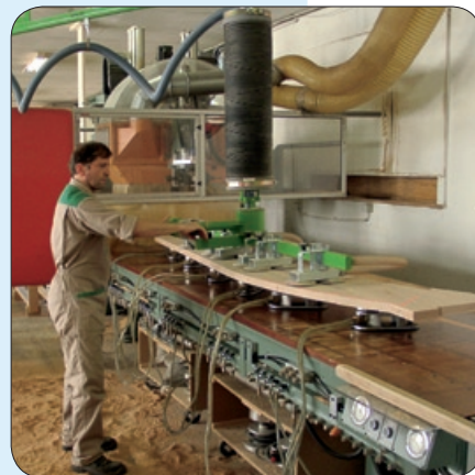
Bild 2 Fig. 2 Transport von beschichteten Spanplatten, Schlauchheber mit verlängertem Bediengriff Transportation of coated chipboards, hose lifter with extended operating handle
