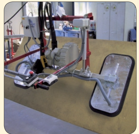
Bild 3 Fig. 3 Schwenken von luftdurchlässigen Spanplatten, elektromotorische Schwenkeinrichtung, Seitenkanalverdichter mit Sicherheitsnachlaufschwungmasse Pivoting of air permeable chipboards, pivoting unit with electric motor, side channel compressor with safety run-on flywheel
