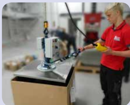
Независимое от сети устройство (AERO 250/1R)
