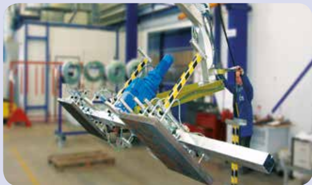
Поворотное устройство для тяжелых грузов (свыше 1.000 кг)
