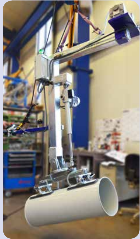
Поворотное устройство для труб
