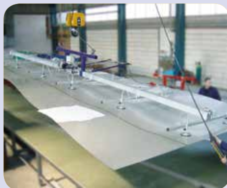
Переноска тонких листов специальной формы
