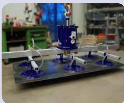
BASIC-LIFT грузоподъемность 600 кг (BL 600/6L)
