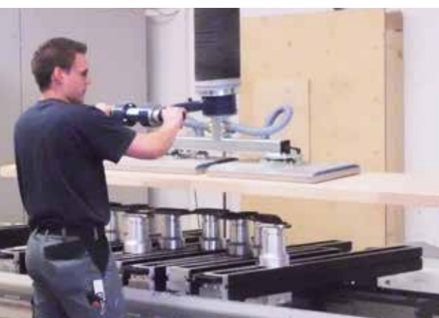
Handling von Holzbalken mit VUSS-Saugfuß
