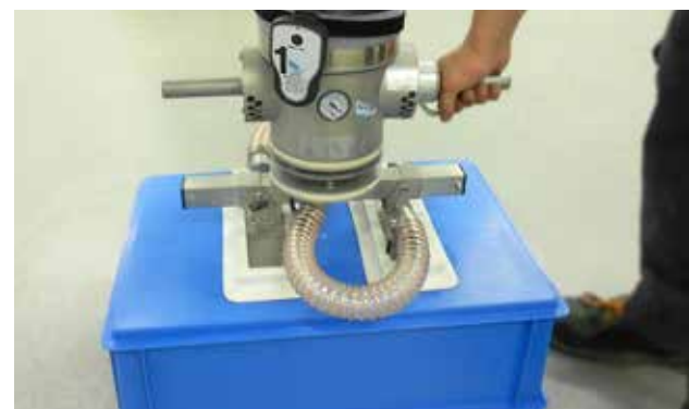
Bedienkopf in Edelstahl rostfrei mit Funksender
