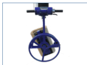
Saugfuß zum Greifen und Drehen von Kaminsteinen
