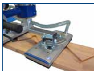
Flächengreifer für Holz mit Aussparungen
