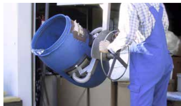
Manuelles Schwenken mit Handrad
