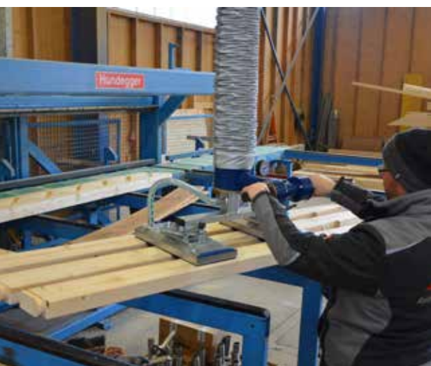
MULTI-LIFT mit Flächengreifer-Saugfuß für Holzleisten
