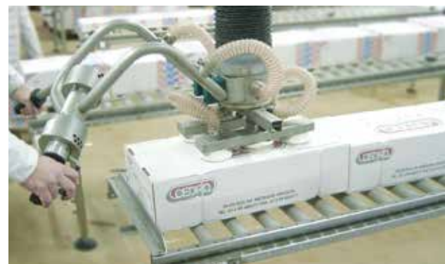
Abwinkelbarer Bediengriff in Edelstahl rostfrei
