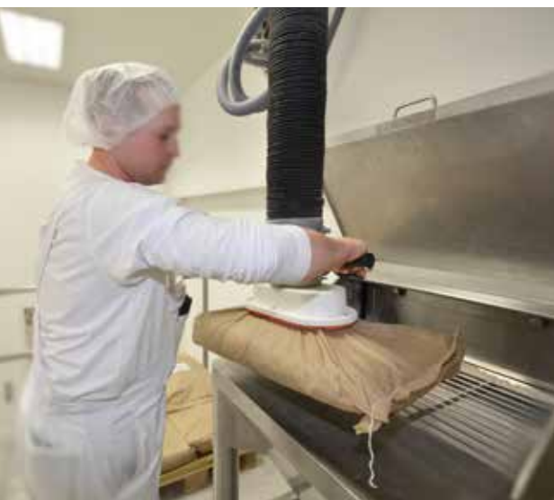
Handling von Säcken im Ex-Schutz-Bereich
