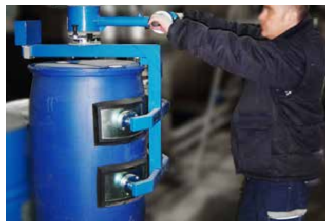
Vertikale Aufnahme von Fässern
