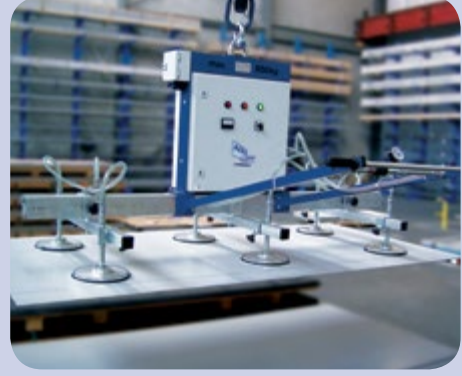
Metal levhaların vakumlu kaldırma ile taşınması
