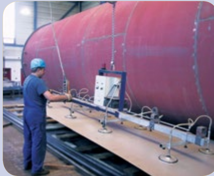
Sac Levahlar İçin Şebekeden Bağımsız 1000 kg Taşıma Kapasiteli Akülü Vakumlu Kaldırma Cihazları
