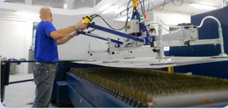
AERO 900/6R vakumlu kaldırma sistemiyle lazer kesim tezgahlarına rahatlıkla sac levha yükleme imkanı
