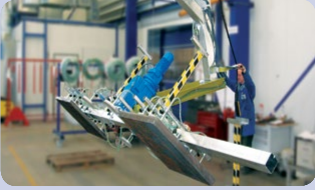
Ağır yüklerinizin (1000 kg üzeri) vakumlu kaldırıcı ile çevrilmesi
