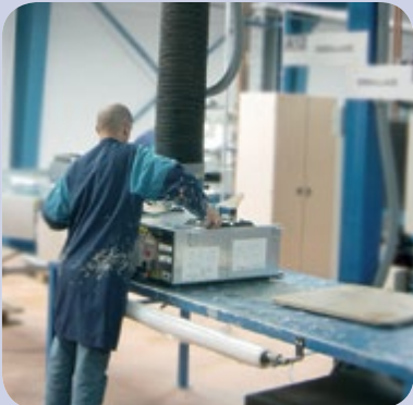
Hortumlu Kaldırıcıyla Para Terminal Kasalarının Kaldırılması
